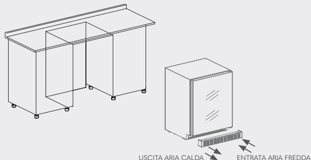
PER IL CORRETTO FUNZIONAMENTO DEL PRODOTTO DA INCASSO A QUALSIASI ALTEZZA, È NECESSARIO LASCIARE VENTILAZIONI ALTE E BASSE. L'ARIA A TEMPERATURA AMBIENTE PENETRA ATTRAVERSO LA GRIGLIA DI VENTILAZIONE DELLA PARTE INFERIORE, SI TRASFORMA IN ARIA CALDA A CONTATTO CON IL DISPOSITIVO E FUORIESCE DALLA PARTE SUPERIORE (VEDERE LO SCHEMA DI AERAZIONE).
