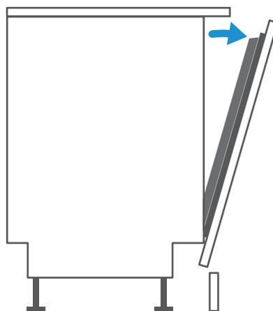
La porta si apre automaticamente al termine del ciclo migliorando i risultati dell'asciugatura e riducendo il consumo di energia.
